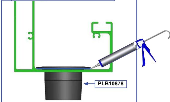
**C Guider le tube PVC sur la bague.**
