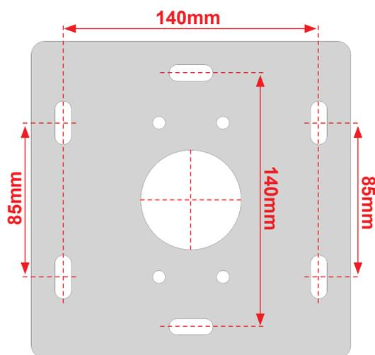
Fixer les platines au niveau de chaque plot béton réalisé auparavant par deux vis minimum.
