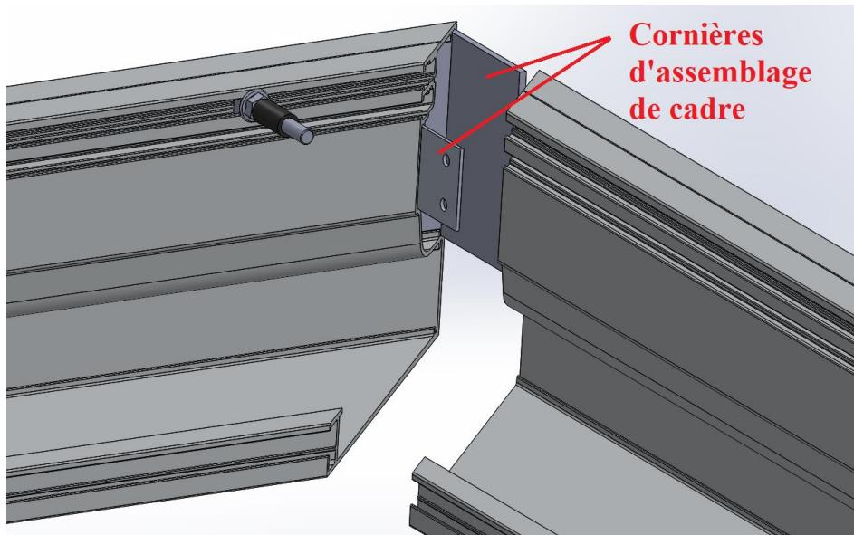
Puis remettre les vis d'assemblage et biens serrés.
