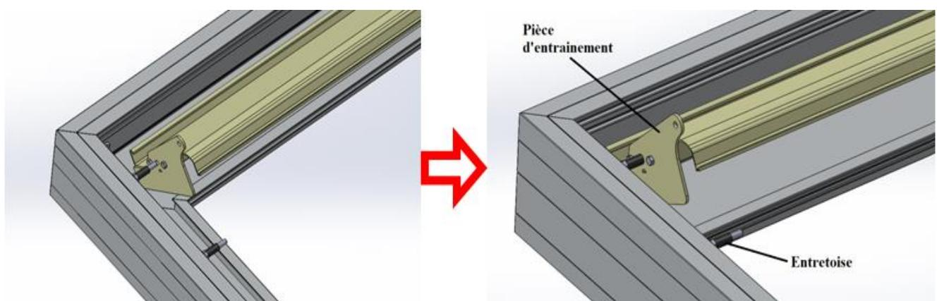
Après, répéter cette action pour le reste des lames à part les 3 à côté du vérin (peuvent être identifiés par le pré perçage vérin et le goujon d'entraînement lames) qu'il faut laisser jusqu'à la fin de la pose afin d'assurer l'accès au vérin.
