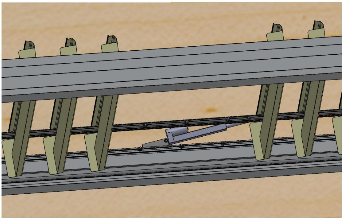
Après, fermer les lames par la télécommande, et s'assurer qu'elles sont bien fermées avant de serrer la deuxième vis du support vérin.
