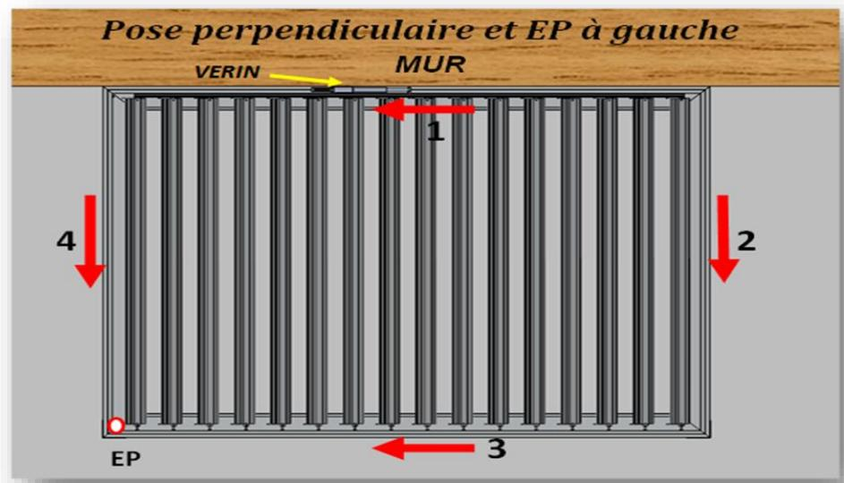
Evacuation à effectuer sur chantier. Percer les angles du cadre de la pergola à la scie cloche diamètre 50 mm
